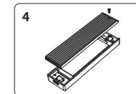
4. Stringere i bulloni del coperchio superiore per fissare e completare l'installazione.
