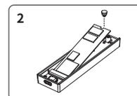
2. Installare l'SSD M.2 e fissarlo con un tappo in silicone.
